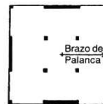
Localización de Muros de Corte para resistir el vuelco y momentos torsionales
