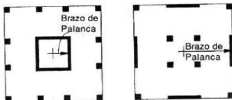
Figura 3. Ubicación de muros de corte para resistir los momentos de volteo y torsión
